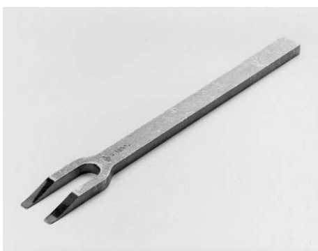
7. Abdrückgabel für Druckstück mit Faltenbalg SAF-Teile-Nr. 4 434 1065 00
