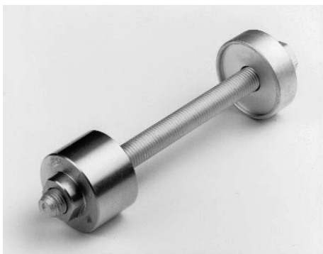
5. Einzieher für inneren Faltenbalg (Sattellagerung) SAF-Teile-Nr. 4 434 1063 00
