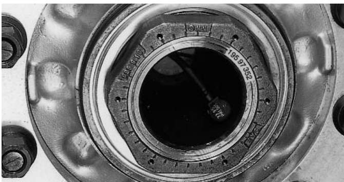
Identifizierung bei fehlendem Typschild Produktions-Nr. der Achse in Fahrtrichtung rechts auf Achsrohr
