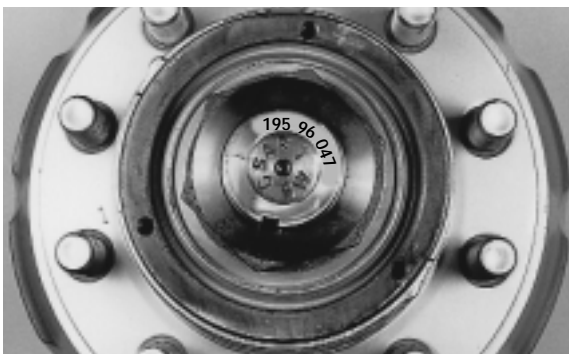
Identifizierung bei fehlendem Typschild Produktions-Nr. der Achse in Fahrtrichtung rechts auf Achsrohr
