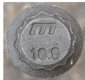
Nachbauschraube mit geringerer Festigkeit 10.9
