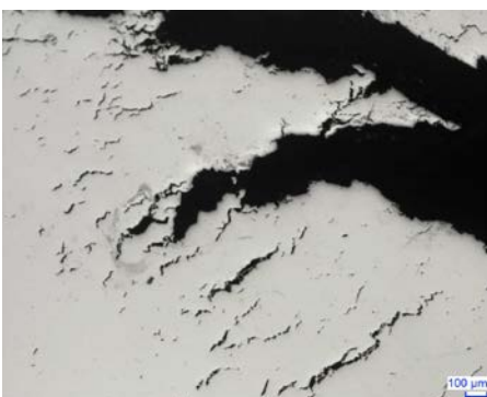
Mikroskopische Risse rund um den Schraubenkopf an der Nachbau-Schraube.
