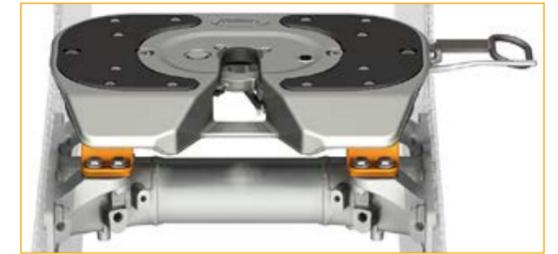
Klar gewichtsoptimiert: Die Integration der Sattelkupplungen in den Fahrzeugrahmen senkt deutlich das Eigengewicht der Zugmaschine.
