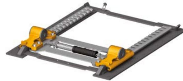
Sattelast: 20.000 kg Bauhöhen: 180, 200, 225 mm
