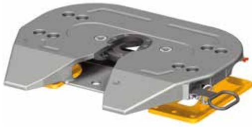
**Die 36-t-Sattelkupplung aus Stahlguss für den Schwerlasttransport**
