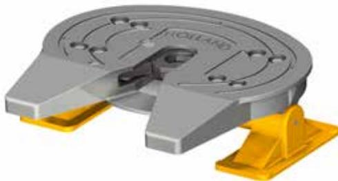
**Die 45-t-Schwerlast-Sattelkupplung aus hochfestem Stahlguss für den Heavy-Duty-Einsatz**
