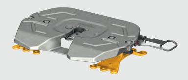
Alle Sattelkupplungen der Serie SK-S 36.20 von HOLLAND sind durch ihren Sphäroguss besonders leicht und langlebig und verfügen standardmäßig über eine Sicherheitseinrichtung, die das Auf- und Absatteln komfortabel mit nur einer Hand ermöglicht.
