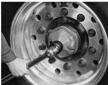
Achsmutter lösen und vom Achsstummel abschrauben.
