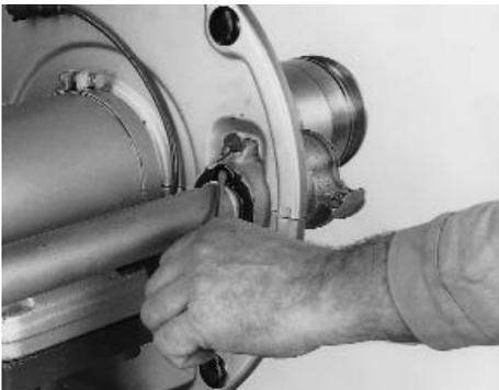
Sicherungsring aus der Nut der Nockenwelle herausnehmen.
