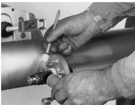
Die Kunststofflagerbuchse in der Kugelbefestigungsplatte zur Nockenwelle ausrichten, die Befestigungsschrauben anziehen, und die Nockenwelle auf leichtgängige Drehbarkeit prüfen.
