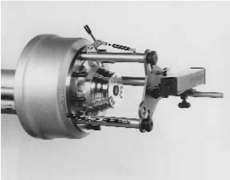
**Für die Durchführung der Spurlaufkontrolle an den SAF Achs-Typen Baureihen SK sind handelsübliche optische Meßgeräte zu benutzen.**
