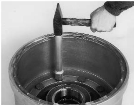
Die Radbolzen mit einem werkstattüblichen Montagedorn bis zur Anschlagenebene am Bremstrommelflansch einschlagen. Verdrehsicherung beachten.
