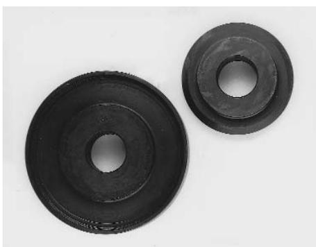
**4. Spannringe für Bremstrommeldrehbank**
