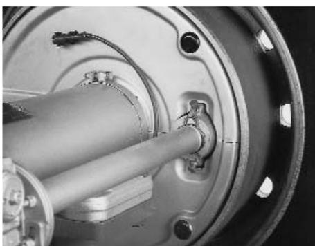
1. Die Radanlageflächen an Radschüssel und Radnabe sowie die Radmutterauflagefläche an der Radschüssel dürfen nicht zusätzlich überlackiert werden. Die Anlageflächen müssen sauber, glatt und fettfrei sein. Bei Nichtbeachtung besteht die Gefahr des LöSENS der Radbefestigung. Etwaige Hinweise des Radherstellers sind zu beachten.
