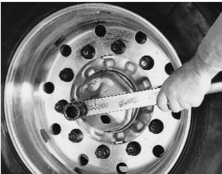
Achsmutter SW 140 in Fahrtrichtung links – Linksgewinde
