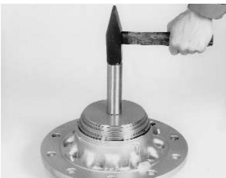
Dichtringe mit dem Montagewerkzeug SAF-Teile-Nr. 3 434 1043 00 beidseitig bis zum Nabenrand bündig einpressen.
