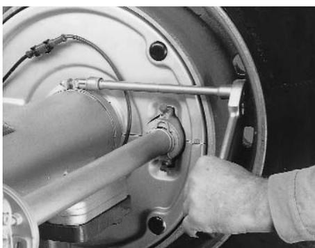
Am ABV-Sensorkabel mit Voltmeter die Spannungsabgabe prüfen (ca. 100 mV), dabei Bremstrommel drehen, ggf. Sensor prüfen.
