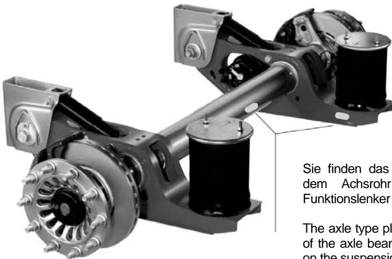
Sie finden das Achstypenschild wie bisher mittig auf dem Achsrohr bzw. bei INTRA-Aggregaten am Funktionslenker unterhalb des Luftfederbalges.
