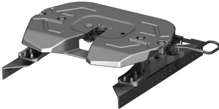
Vorteil: Die Befestigung mittels Winkelschiene bei Volvo-Fahrzeugen erfordert keine zusätzliche Montageplatte.
