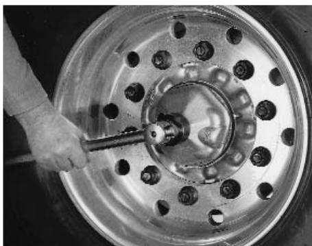
Achsmutter lösen und vom Achsstummel abschrauben.
