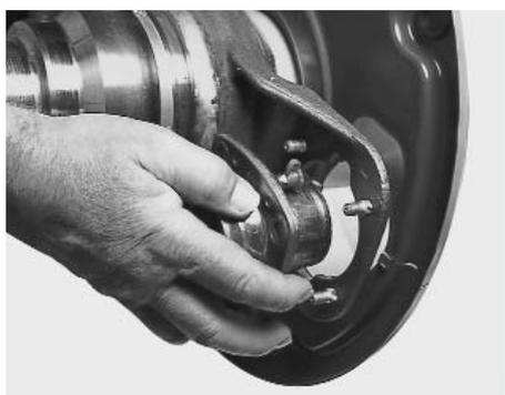
Nach dem Einbau des neuen Kompaktlagers muß sich die Nockenwelle leichtgängig drehen lassen, dann Schrauben und Muttern ansetzen.
