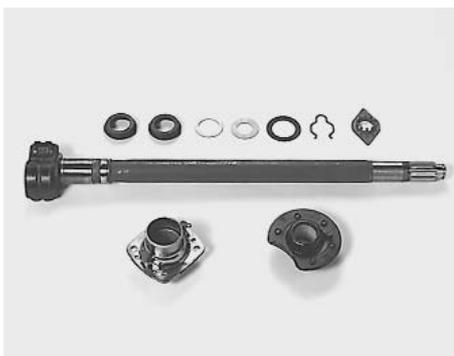
Schrauben aus Kompaktlager herausdrehen und durch neues Lager ersetzen (siehe Seite 10 Pos. 81 mit Teilen 85.1 - 88.1 und Pos. 10 mit Teilen 12, 15 u. 18).
