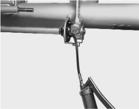
Gestängesteller und Verschleißanzeiger einbauen, beide Abdeckbleche einsetzen und mit der Spannschelle am Achsrohr befestigen.
