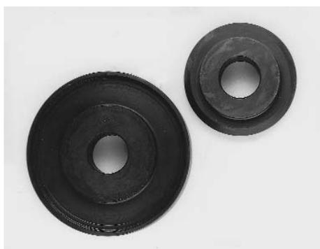
**4. Spannringe für Bremstrommeldrehbank**
