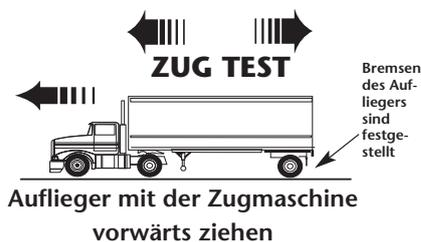
**HINWEIS** Ohne abschließende Kontrolle ist der Kupplungsvorgang nicht vollständig abgeschlossen. Dazu muß aus der Zugmaschine ausgestiegen und die im folgenden beschriebene Sichtprüfung durchgeführt werden.
