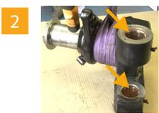
Achsschenkel mit oberer und unterer Lagerbuchse.
