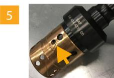
Neue Lagerbuchsen mit dem Montagedorn 04 434 4235 00 eintreiben. Bis die Lagerbuchse bündig zur Achsfaust positioniert ist. Lagerbuchse darf keinen Überstand haben.
