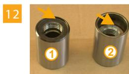
Die neuen Gleitbolzen mit 6-Kantschraube M36x150 in den Lenkschenkel einsetzen.
