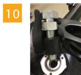
Oberen und unteren Gleitbolzen mit Buchse für Montage / Demontage 04 434 4236 00 und 6-Kantschraube M36x150 und Mutter M36 ausziehen.
