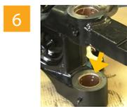
Neue Lagerbuchsen mit dem Montagedorn 04 434 4235 00 eintreiben. Bis die Lagerbuchse bündig zur Achsfaust positioniert ist. Lagerbuchse darf keinen Überstand haben.
