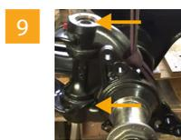
Achsschenkel mit oberer und unterer Lagerbuchse.
