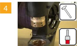
Neue Lagerbuchsen auf Montagedorn 04 434 4235 00 aufsetzen. Auf die Position der Schmierkanäle achten - gelber Pfeil !
