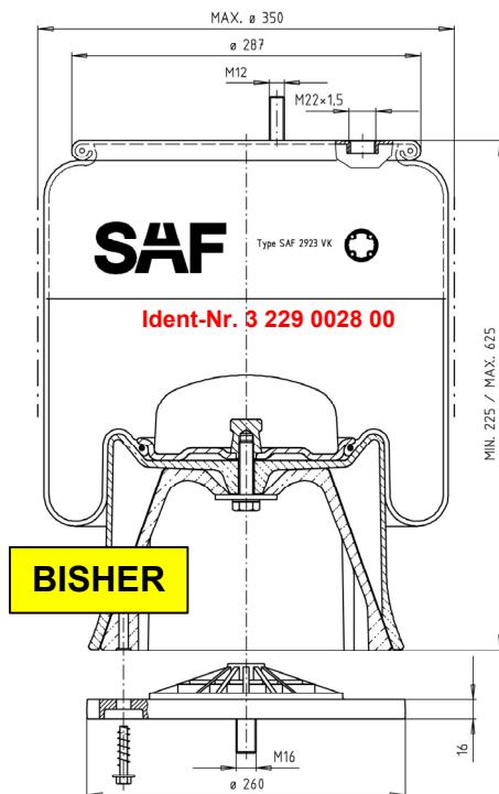
Der NEUE Luftfederbalg unterscheidet sich vom BISHERIGEN hauptsächlich durch die Neukonstruktion des Tauchkolbens und der wesentlich einfacheren Montage des Luftfederbalges am INTRA Funktionslenker.
