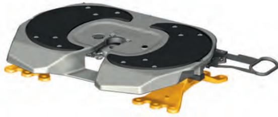
**Die leichte, wartungsarme 20-t-Sattelkupplung aus Sphäroguss**
