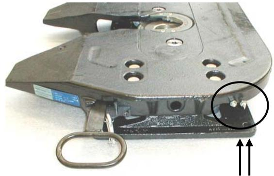
Anschluß für Zentralschmierung ist möglich
