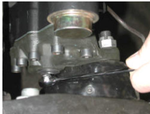
Insbesondere bei den Bremsen **KNORR und WABCO** wird durch den SAF Ratschenschlüssel der Arbeitsvorgang von Prüf – und Einstellarbeiten deutlich vereinfacht.
