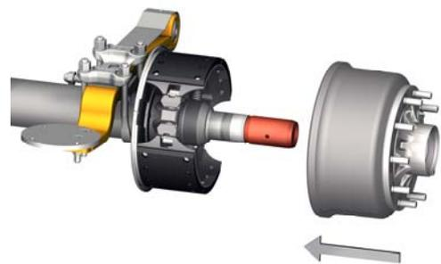
Abb.3 Montage bei trommelgebremsten Achsen
