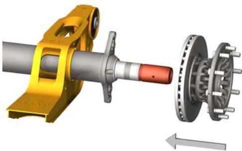
Abb.2 Montage bei scheibengebremsten Achsen
