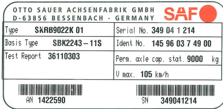
Mit Einsatz der speziell für den Trailer konzipierten Scheibenbremse (SAF Wichtige Info 29) wurde dies auch auf dem Typenschild dokumentiert.
